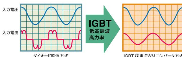
入力電流の等価逆相電流は 15% 以下になり、非常用エンジン発電機の容量を大幅に小さくできます。
